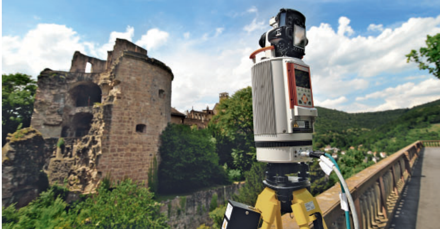
3 Riegl-Scanner vor der Kulisse des „Gesprengten Turms“.
